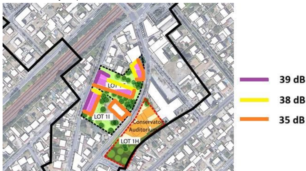
Isolement de façade pour lots 1I et 1G
