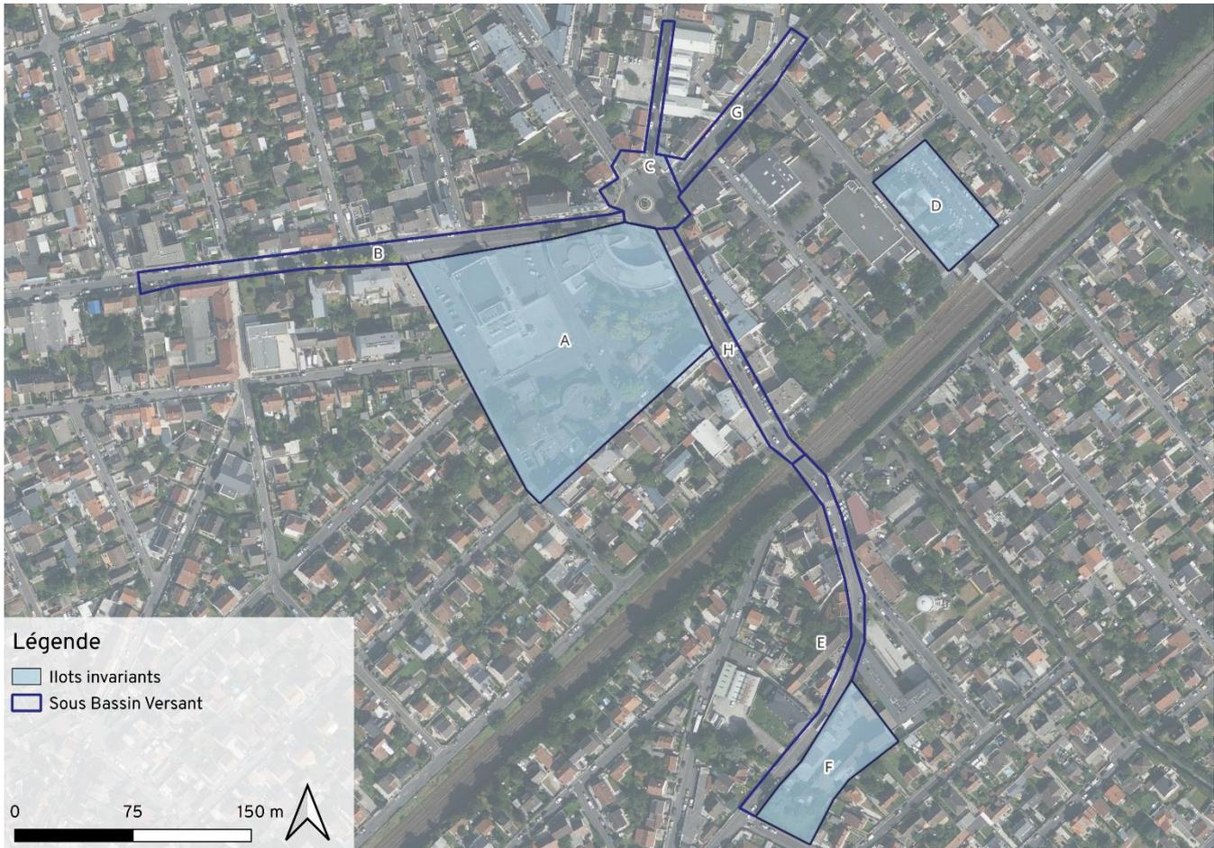
SCHEMA 13 : SOUS BASSIN VERSANT RETENUS POUR LA PROPOSITION DE SYSTEMES DE GESTION D'EAUX PLUVIALES
