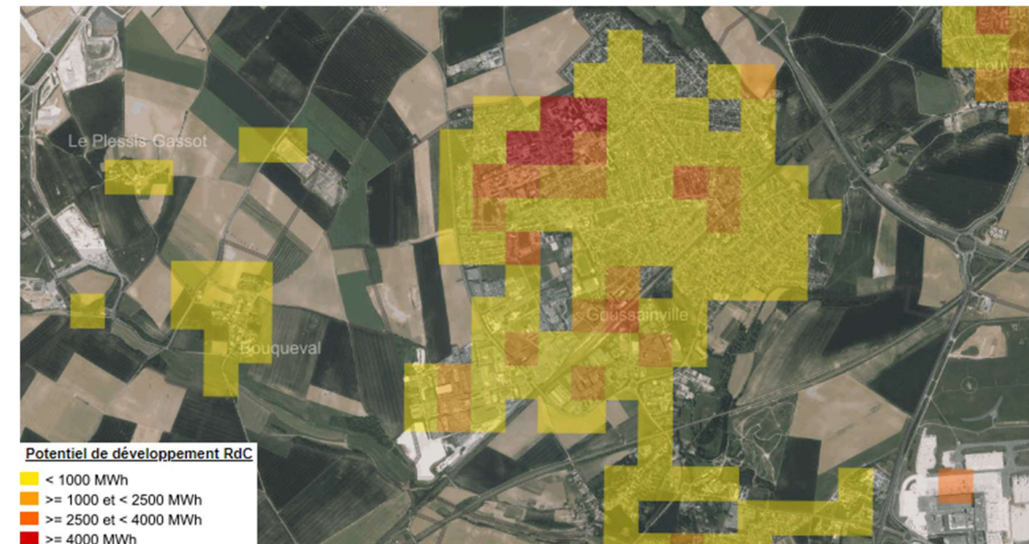
Schéma 18 : Potentiel de développement du réseau de chaleur du centre-ville (Source : DRIEAT Ile de France)
